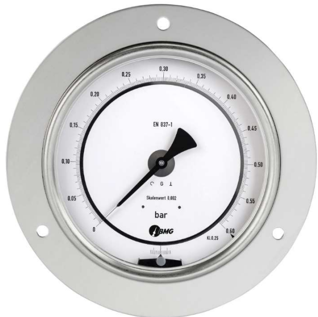
Feinmess-Rohrfedermanometer Typ 5579VBR Bild zeigt Anzeigebereich 0...0,6 bar spiegelhinterlegte Skala Genauigkeitsklasse 0,25 Edelstahlgehäuse NG Ø 250 mm Vorderer Befestigungsrand Edelstahl mit Messinganschluss, G1/2B rückseitig
