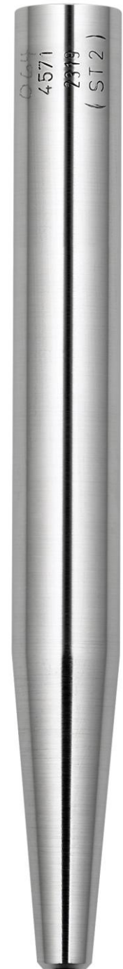
Schutzrohr nach DIN43772 Form4 Gesamtlänge L= 200mm Einbaulänge U= 65mm
