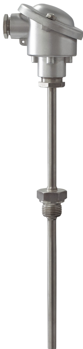
Widerstandsthermometer mit Anschlusskopf Form B, Sensor Pt-100, mit Halsrohr, Tauchschaft und Einschraubgewinde G 1/2A in Edelstahl 1.4571
