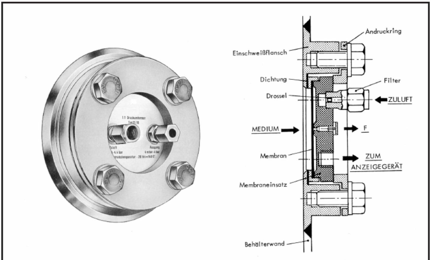
Die 1:1-Druckumformer der Gruppe 21/16 dienen zur Übertragung eines Gas-, Dampf- oder Flüssigkeitsdruckes Auf Luft als Signalträger. Sie sind besonders für die Inhaltsmessung geeignet.
